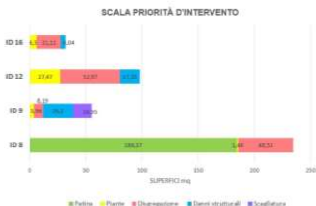
Fig. 3: Scala delle priorità d'intervento ottenuta dalla valutazione condotta in situ .
